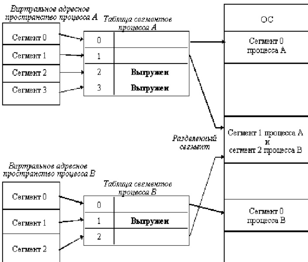
Рис. 5.7. Представление сегментной модели виртуальной памяти
